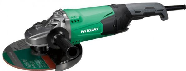
El mejor en durabilidad de su clase - El estator está partido en dos, para una mejor eficiencia en enfriamiento y durabilidad del motor - El motor está protegido contra el polvo y los escombros mediante una construcción en laberinto. Empuñadura antideslizante con alto nivel de agarre.
